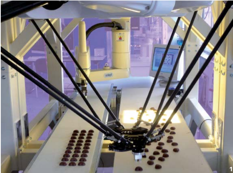
1 Quattro mit Parallel-Kinematik und Cobra-Scara (im Hintergrund hängend montiert) in einer Verpackungszelle für Pralinen.
