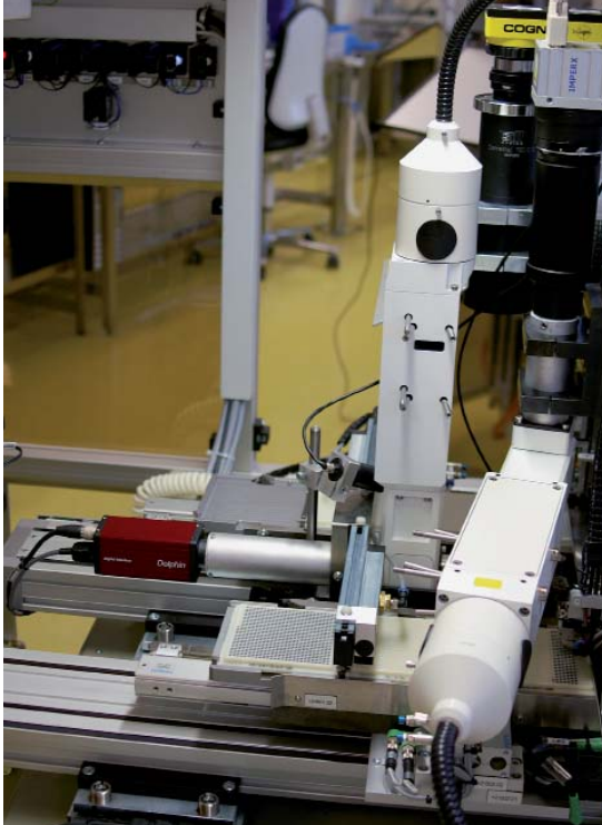
Kamera-Systeme mit Spezialoptik und Beleuchtung von Stemmer für die visuelle Strukturprüfung von 2,0 x 2,5 x 1,3 Millimeter großen Bauteilen.
